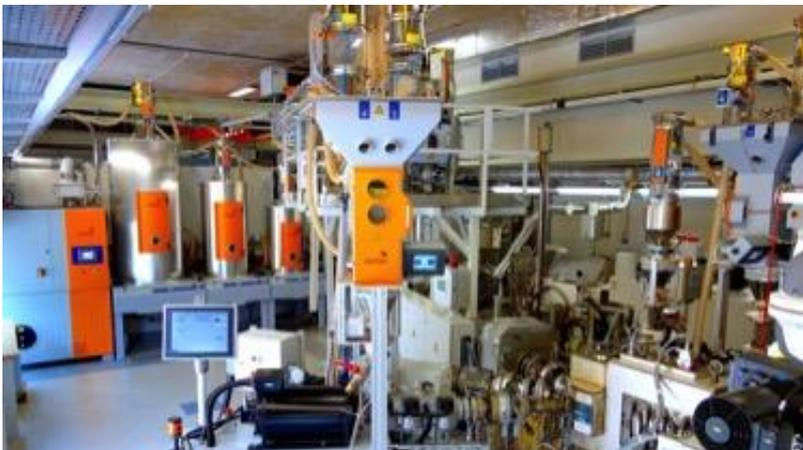
*Die Einrichtungen für die Materialversorgung an der Coextrusionsanlage stammen durchgängig von motan – von der Förderanlage über die Materialtrocknung bis zu gravimetrischen Präzisions-Dosier- und Einfärbegegeräten*
