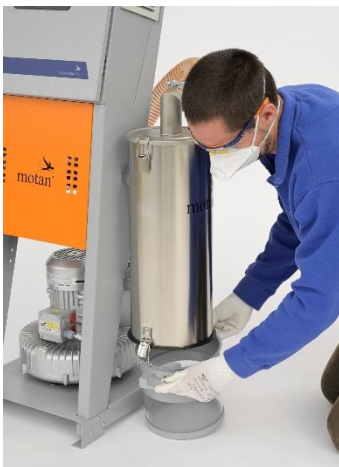
Photo 2: Schnell und einfach gereinigt: der moderne Zyklonfilter mit transparentem Staubsammelbehälter.
