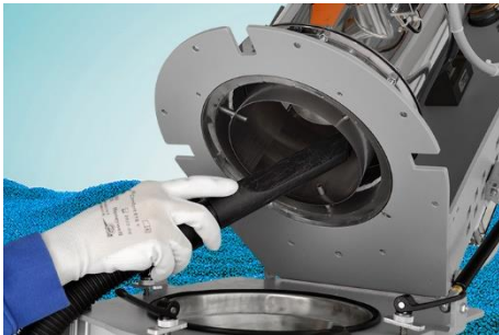
Foto 2: METROFLOW – Einfache Reinigung dank optionalem Klappmechanismus
