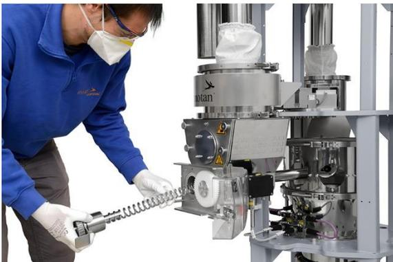
**Photo 2:** SPECTROPLUS-Dosiermodul: Einfacher Wechsel der Dosierschnecke (motan group)
