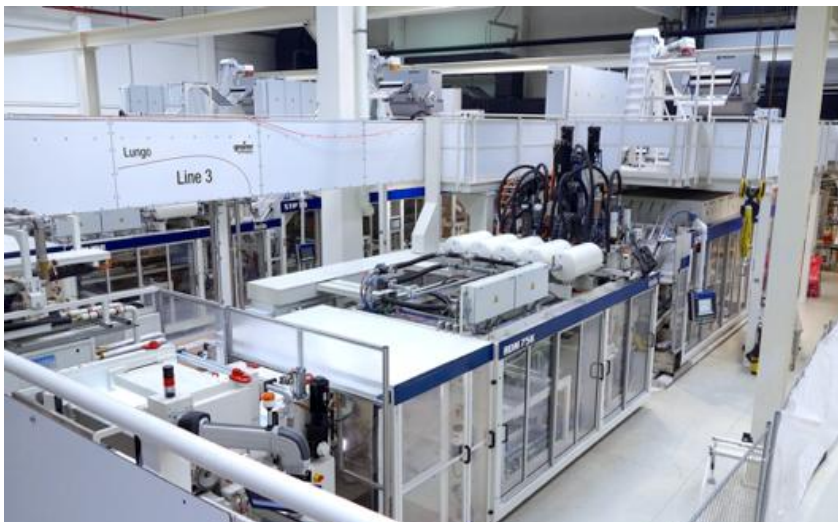
Abb.2: Die aus der Extrusionsanlage kommende 7-Schicht-Barrierefolie läuft direkt in eine Multikavitäten-Tiefzieh- und Stanzanlage. Das zurückbleibende Stanzgitter und allfällig anfallende Schlechteile werden direkt anschließend einer Schneidmühle zugeleitet (im Hintergrund am Maschinenende) und von dort wieder in die Produktion zurückgeführt
