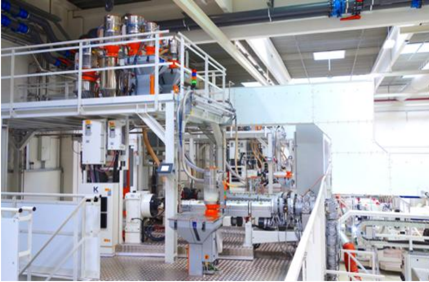
Abb.4: Die 7-Schicht-Folienanlage ist in drei Funktionsebenen übereinander aufgebaut. Auf der untersten Ebene (hier nicht sichtbar) befinden sich drei Extruder (siehe Abb.3), auf Ebene zwei befinden sich die zwei Extruder für die Deckschichten, auf der obersten Ebene die Dosiergeräte zur Versorgung der darunter befindlichen Extruder
