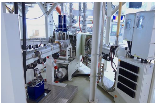
Abb.3: Zur Herstellung der 7-Schicht-Barrierefolie wird ein 5-Aggregate-Extruder eingesetzt. Der zentrale Extruder ist für 70 Prozent der Folie in Form des Recyclinganteils verantwortlich. Flankiert wird er von den Extrudern für die Barrierschicht und die Haftvermittler-Schichten. Auf einer darüber angeordneten Produktionsebene befinden sich die Extruder für die PP-Deckschichten, die über vertikale Schmelzleitungen (im Hintergrund zu sehen) an den Feed-Block angebunden sind
